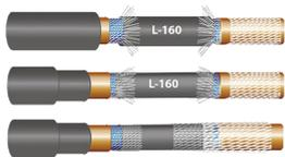
Для соединения экранирующих оплётки необходимо расправить оплётки с двух сторон соединения и надеть сверху медный чулок.
