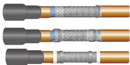
На соединение одеть трубку **19x220 мм** и усадить при помощи фена. **(Рис. 8)**
